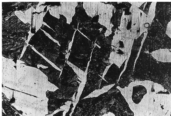
Рис. 45. Микроструктура перегретой доэвтектоидной стали \times 300
