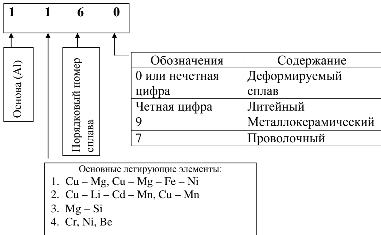
Рис. 39. Принципы цифровой маркировки алюминиевых сплавов
