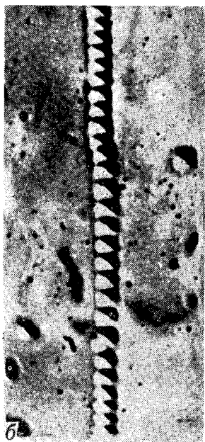
Рис. 6. Схема простой дислокационной границы (а) и реальная дислокационная граница в монокристалле LiF (б), проявленная травлением. Увеличение 300.
