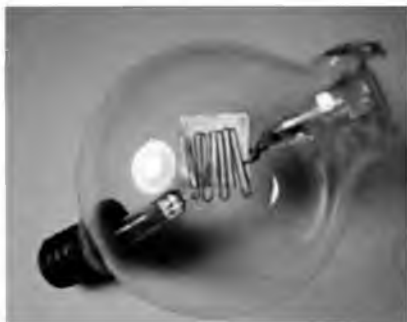
Рис. 3.14. Одна из первых ламп Ли де Фореста
