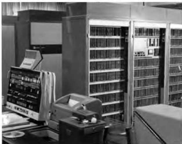
Рис. 4.10. Пульт управления и арифметическое устройство машины Atlas
